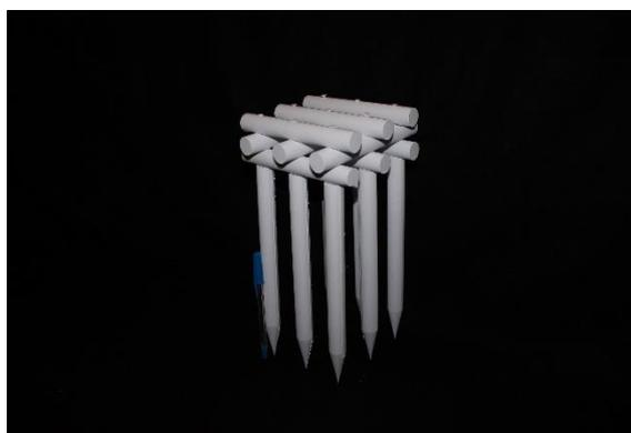
Figura 94. Resultado final do modelo de detalhe das estacas de fundação (escala 1:10).
