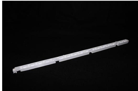
Figura 82. Peça inacabada por falta de material.
