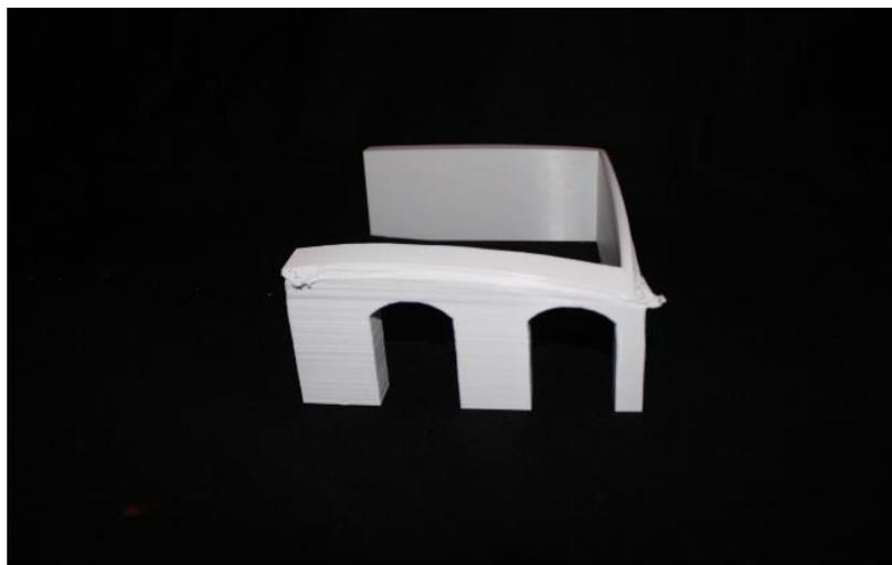
Figura 35. Peça deformada por falta de aderência à base da impressora.
