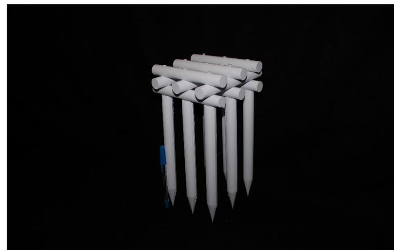
Figura 47. Sequência de fotografias ilustrativas da montagem do modelo de detalhe das estacas de fundação (1:10).
