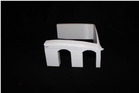
Figura 81. Peça deformada por falta de aderência à base da impressora.
