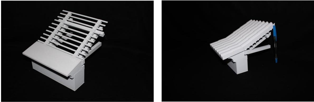
Figura 88. Sequência de montagem do detalhe da cobertura.
