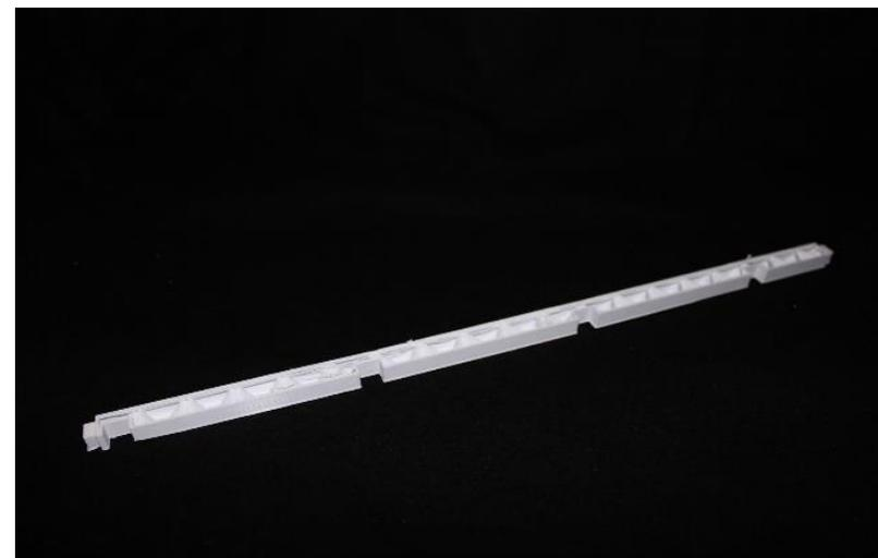
Figura 36. Peça inacabada por falta de material.
